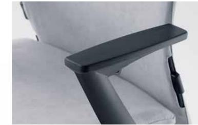
**MF-Armsupports.** Fünf Funktionen: Höhenverstellbar um 11,5 cm und horizontal nach vorne um 8 cm verstellbar. Armauflagen in der Breite um je 5 cm insgesamt (+3 cm unter dem Sitz) verstellbar und nach rechts und links um je 15° schwenkbar. Einstellung in der jeweiligen Position arretierbar.
